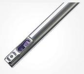
В этих жестких бороскопах направление обзора может постоянно изменяться от наклона вперед до просмотра назад – в сочетании с полем зрения достигается общая дуга обзора от 120° до 140°.
