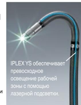
IPLEX YS обеспечивает превосходное освещение рабочей зоны с помощью лазерной подсветки.
