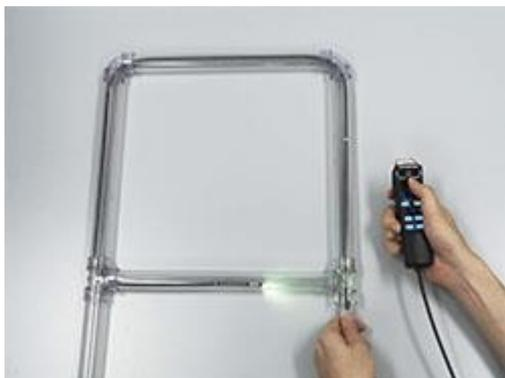
Рабочая часть (зонд), выполненная по технологии Tapered Flex, сочетает великолепную маневренность, оптимизированную прочность и универсальность, что обеспечивает быстрый и простой доступ к интересующим участкам. Зонды имеют четырехслойную конструкцию и вольфрамовую внешнюю оплетку для обеспечения надежности и эластичности.
