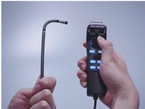
Абсолютно новая конструкция с электроприводом улучшила характеристики прибора с технологией TrueFeel, обеспечив быстроту отклика и скорость работы. Контролеры могут легко управлять видеоскопом благодаря небольшому весу и эргономичности конструкции, что снижает усталость оператора.
