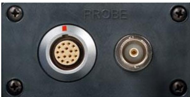
Все модели NORTEC 600 имеют стандартный универсальный 16-контактный разъем LEMO, а также разъем BNC для абсолютных преобразователей. Выберите разъем в меню прибора. При использовании разъема BNC прибор активирует функцию автоматической балансировки.
